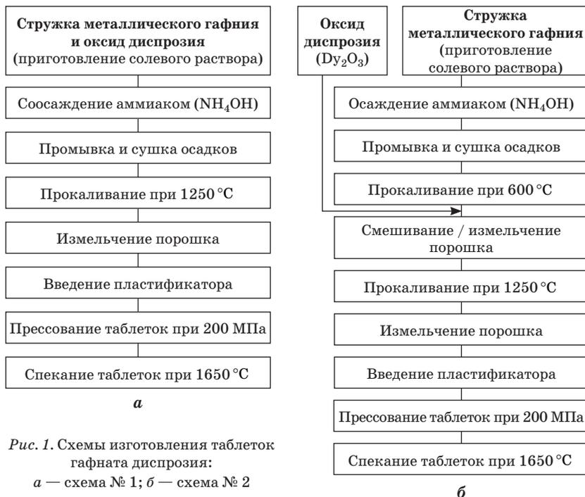
Рис. 1. Схемы изготовления таблеток гафната диспрозия:
